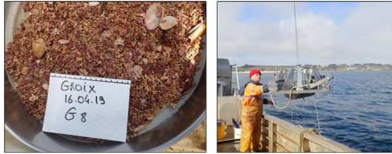
Figure 5. Manipulation de la benne Day et prélèvement de maërl.
