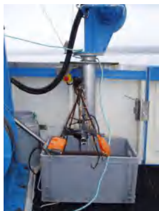
Figure 5 : Caméra sous-marine. (Cliché TBM)
